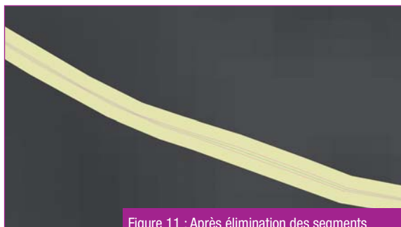
Figure 11 : Après élimination des segments « latéraux », il ne reste plus que l'axe du corridor.
