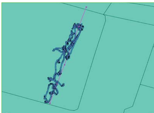
Figure 8 : Comparaison du plan de vol manuel (en bleu) et calculé automatiquement (en rouge).
