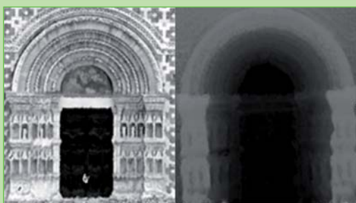
Figure 10 : Détail architecture et rendu hypsométrique réalisé à partir des acquisitions.
