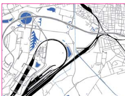
Création de réseaux surfaciques à l'aide des pré-géométries de la BD Topo® (routier = gris - ferré = noir - hydro = bleu).
