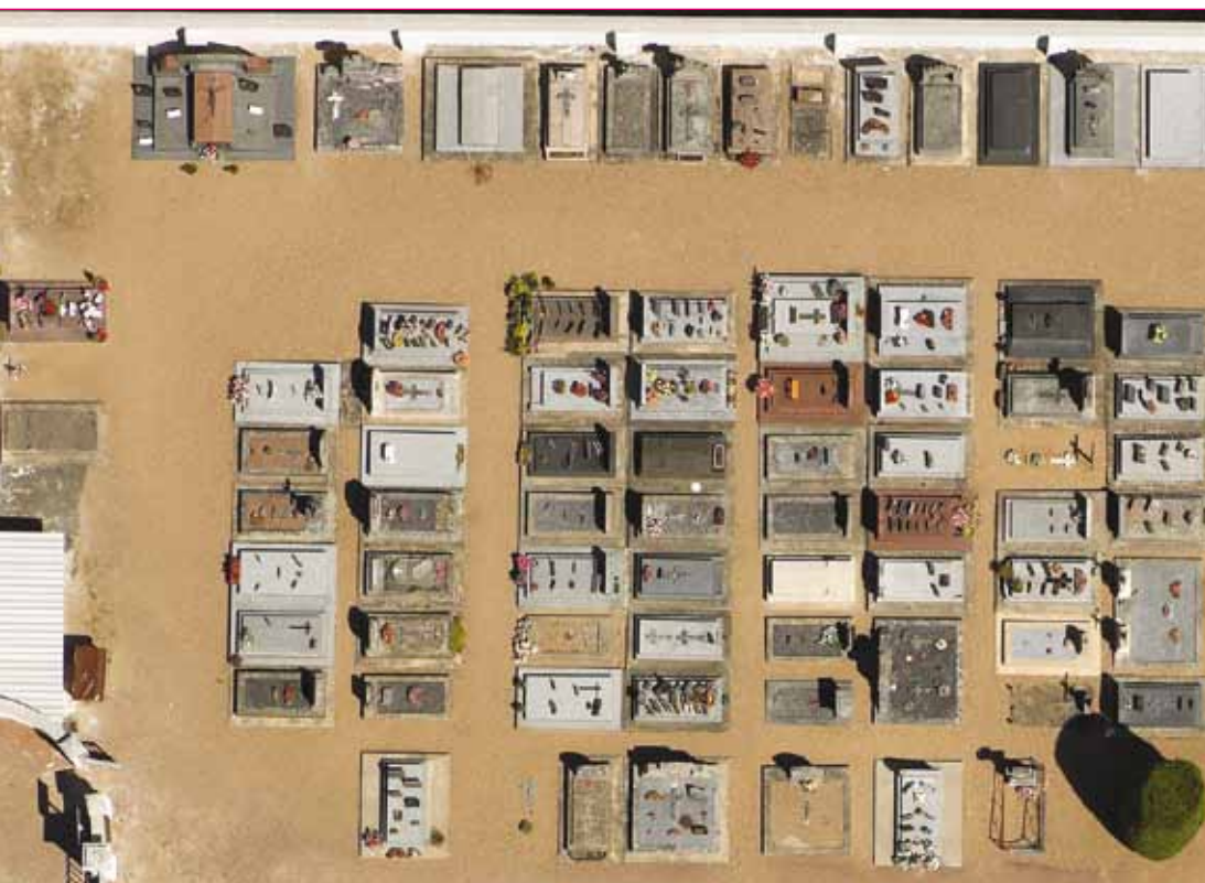
Exemple d'une orthophotographie de cimetière à 2 cm/pixel. L'Europe vue du ciel se charge ensuite de saisir le contour des tombes pour rendre une couche vectorielle intégrable sur un SIG.
