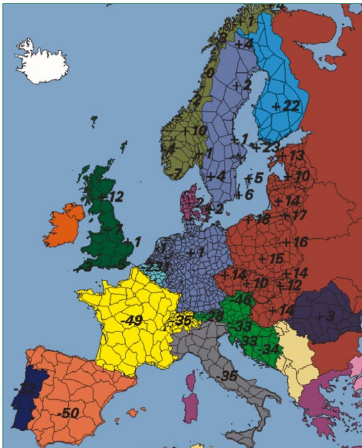
Intégration des différents réseaux de nivellement nationaux au sein d'un réseau européen unifié, avec les corrections nécessitées par l'utilisation de références diverses.
