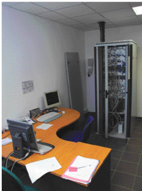
Pour assurer sa connectivité Internet, la communauté dispose d'un simple modèle ADSL version « pro », et d'un serveur PostGis+Apache+MapServer qui n'est autre qu'un simple PC de bureau relativement récent.
