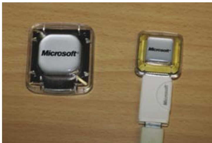
À chaque génération, la taille des GPS diminue. Ici, l'ancien (à gauche) et le nouveau récepteur (à droite). On comparera avec la prise USB.
