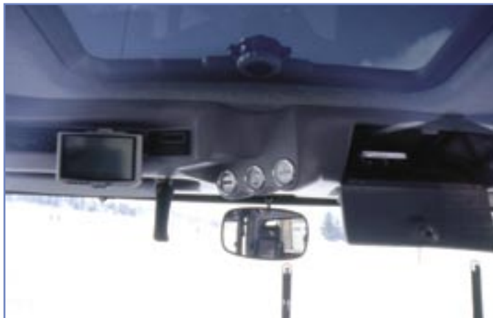
Le PC embarqué à bord de la dameuse tient dans la « boîte à gants », un écran LCD de contrôle étant placé côté conducteur.
