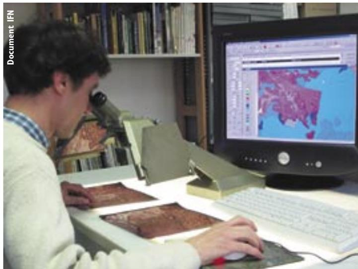
Le photo-interprète dispose (classiquement) d'un système de restitution optique couplé à un ordinateur et une souris. Il délimite avec cette dernière les contours correspondant aux différents zonages.
