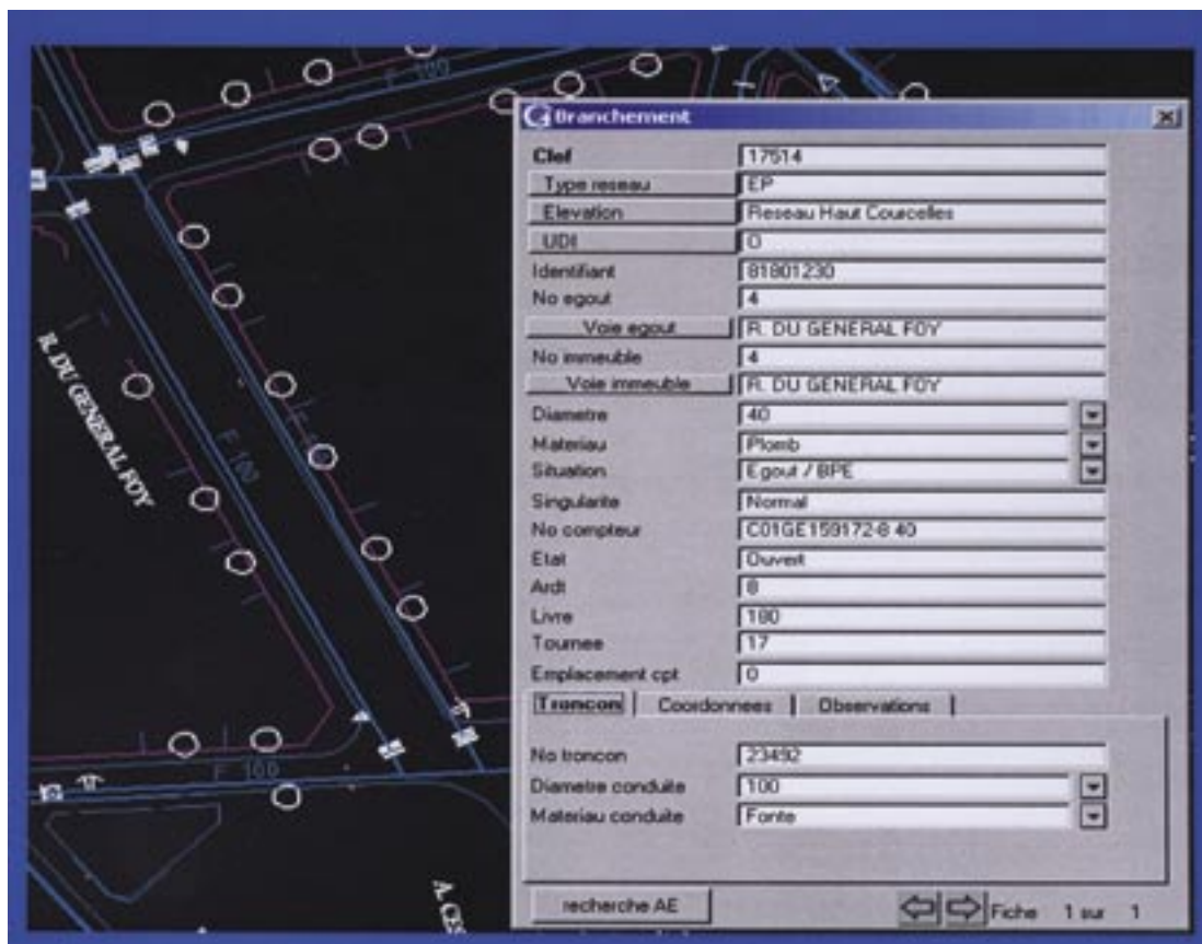
L'utilité patrimoniale du SIG est évidente. Ici, sur le fond de plan, les branchements sont figurés par des ronds clairs.
