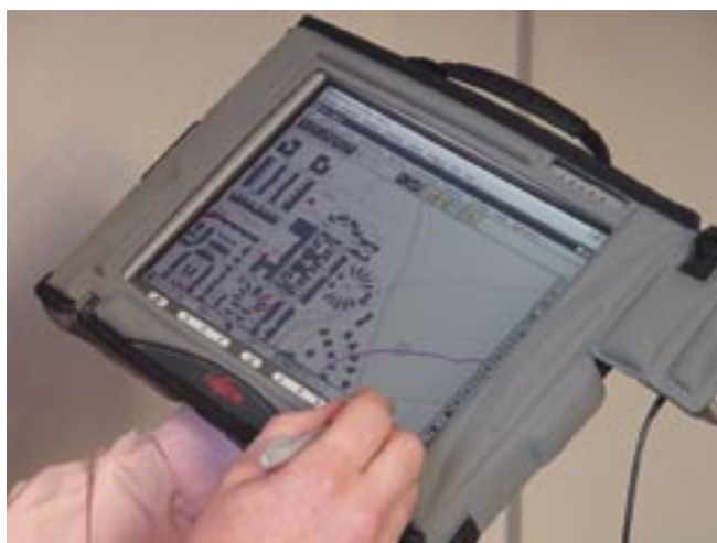
Le SIG APIC sur une ardoise électronique, permet aux techniciens de saisir les modifications ou les remarques in situ.
