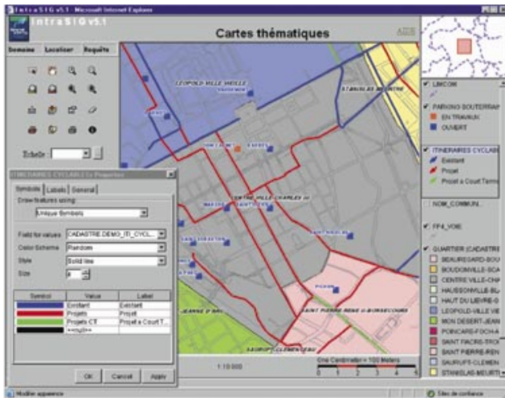
Superposition de linéaires (ici les pistes cyclables) à la voirie et aux quartiers.
