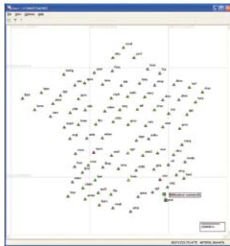
La partie réservée aux utilisateurs du site de TERIA propose un suivi en direct de l'état des stations. Vert : service normal ; orange : service dégradé ; rouge : communications interrompues.
